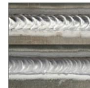
Возможна настройка первого и второго тока с разной амплитудой и длительностью для выполнения простых декоративных вертикальных швов с характерной крупной чешуёй без колебания горелки.
