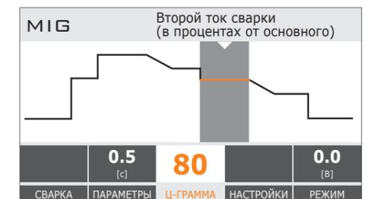
Краткий перечень параметров, настраиваемых в циклограмме в зависимости от режима сварки, приведен ниже. Для полной информации смотрите раздел 3.
