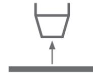
Выбираем в подсвеченном поле значение вылета сварочной проволоки – длина от её торца до торца контактного наконечника (токосъёмника) горелки. Аппарат будет поддерживать этот параметр автоматически после каждого завершения процесса сварки.
