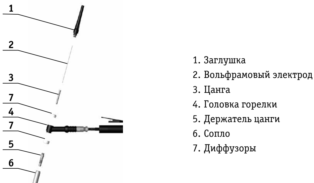
Рисунок 7.2.1 Основные компоненты горелки TIG
