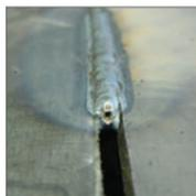
Используется для сварки различных сталей с целью уменьшить энергозатраты, делая второй ток меньше первого. Может быть полезна при такой настройке для сварки с зазором.
