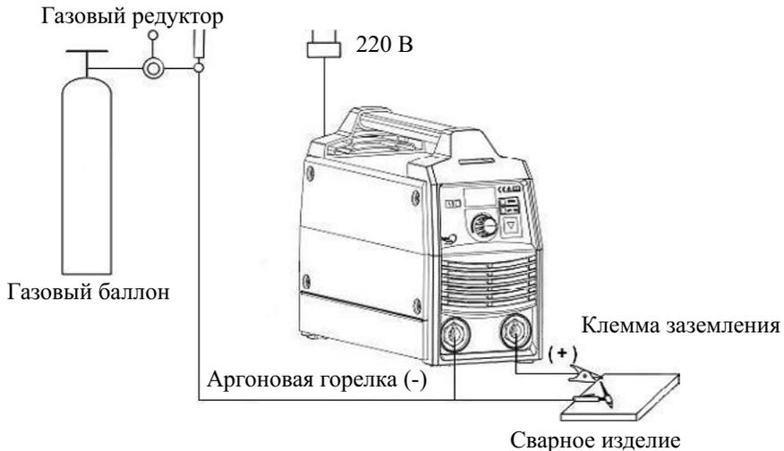
**Обратите внимание на то, что удлинение сетевых кабелей или кабелей горелки, отразится на процессе сварки, так как сопротивление кабеля, определяемое его длиной, будет снижать напряжение. Рекомендуется использовать горелку и сварочные кабели, входящие в комплект поставки.**
