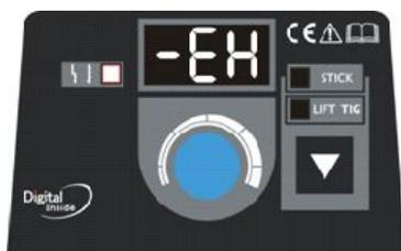
Индикатор загорается в случае, если сварочный аппарат находится в режиме защиты от перегрева и на дисплее появляется код ошибки обозначающий перегрев сварочного инвертора. Перегрев возникает вследствие перегрузки сварочного оборудования. Аппарат автоматически включается снова, когда температура внутри него падает. Индикатор гаснет.
