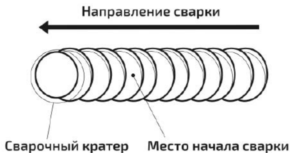
Рис. 11.2.2. Начало сварки при смене электрода.
