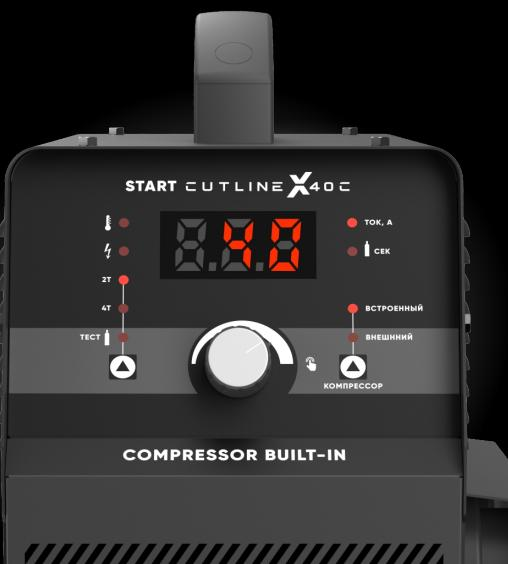
На лицевой панели устройства расположены кнопка переключения режима работы с внешним или встроенным компрессором, регулятор настройки тока резки и времени пост продувки, а также клавиша выбора режима резки 2Т/4Т. Эти элементы управления обеспечивают точную настройку параметров резки и гарантируют удобное и комфортное использование установки в работе.
