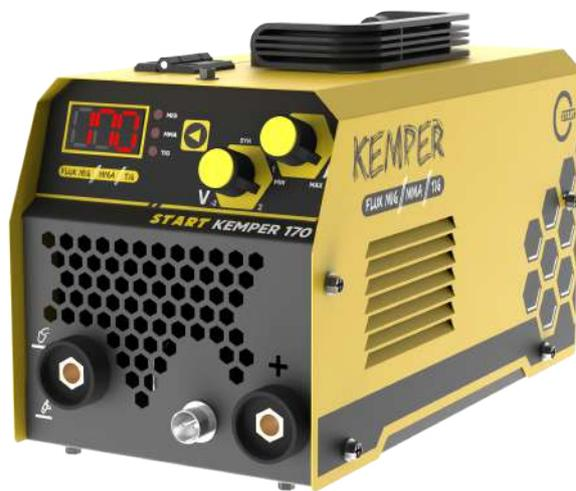
Сварочный полуавтомат хобби класса, предназначенный для полуавтоматической сварки самозащитной (порошковой) проволокой 0,8-1,0 мм в режиме MIG, ручной дуговой сварки штучными электродами MMA, аргодуговой сварки TIG LIFT. Оснащен интуитивно понятной панелью управления, что делает его использование удобным даже для начинающих пользователей.
