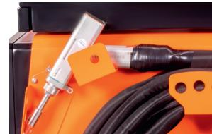
Это устройство фокусировки и направления лазерного луча отличается небольшим весом, эргономичностью и простотой в управлении, которые обеспечивают удобное использование головки. Немаловажно и то, что на корпусе головки есть индикатор, который позволяет контролировать состояние работы системы: он загорается, например, при срабатывании защиты от перегрева.
