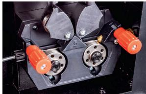
Механизм с четырьмя роликами выполняет стабильную (без рывков, пробуксовок и деформаций) подачу проволоки в область сварки, обеспечивая непрерывность сварочного процесса.
