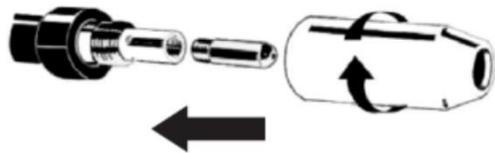
Установите обратно контактную трубку и сопло на горелку.
