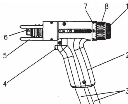
Корпус сварочного пистолета (2) изготовлен из прочного пластика.
