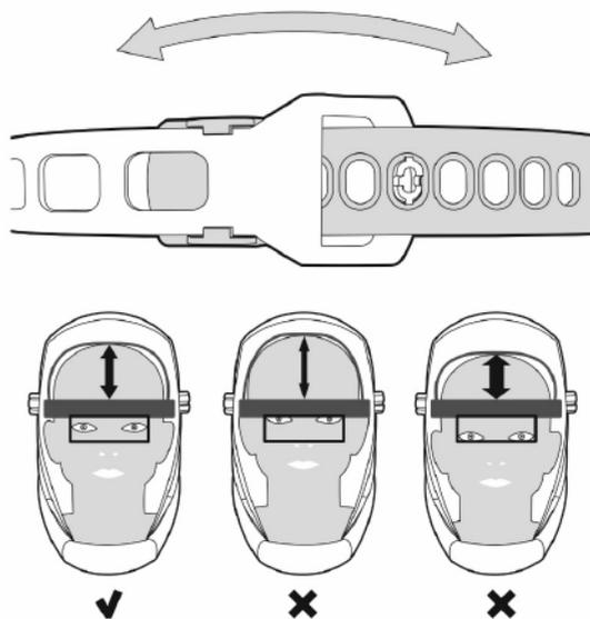
Рис. 8.2.2. Вертикальная регулировка.
