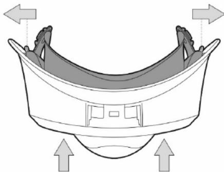
Рис. 9.1.1. Извлечение светофильтра.
