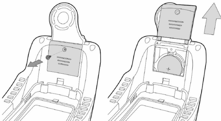
Рис. 9.3.1. Порядок замены батареи в светофильтрах TECH Spotelite.
