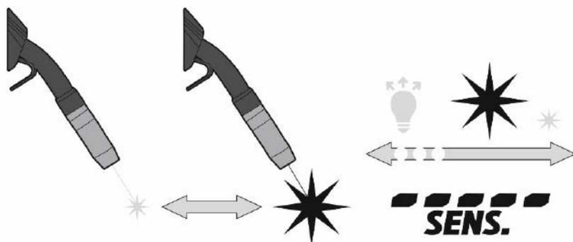
Рис. 10.5.1. Выбор чувствительности датчиков.
