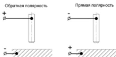
Рис. 9.5. Способы подключения.
