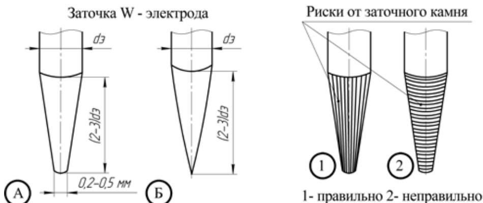
Рис. 8.4. Пример заточки вольфрамового электрода:
