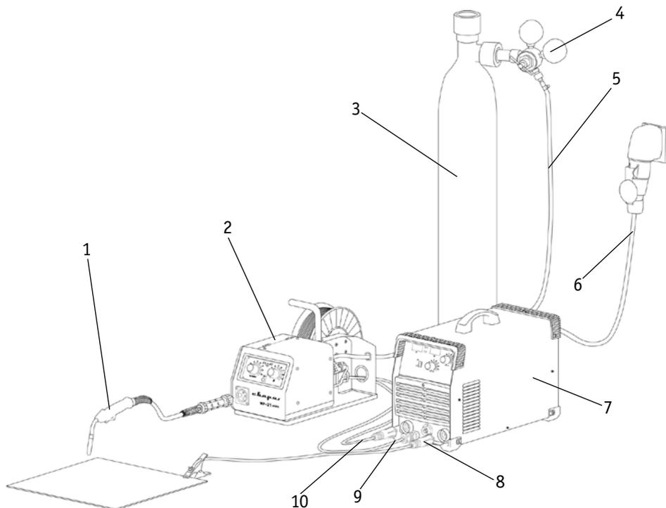
Рис. 8.1. Схема подключения оборудования при сварке сплошной проволокой.
