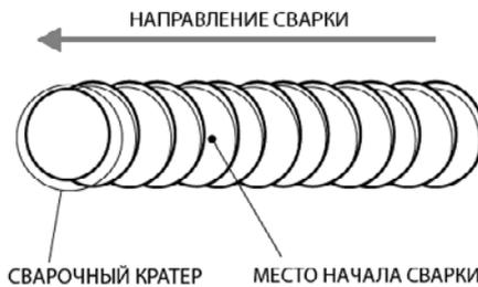
Рис. 11.5. Начало сварки при смене электрода.
