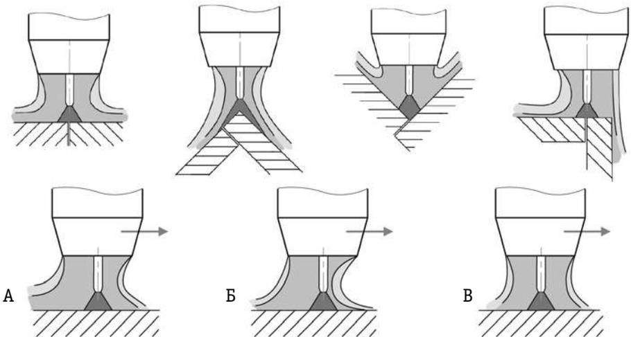
Рис. 9.9. Влияние типа соединения на форму потока.
