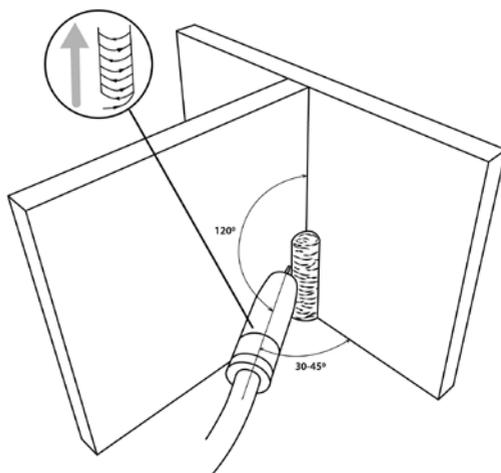
Угол наклона горелки при сварке тонколистового металла.
