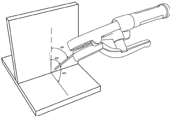
Рис. 11.6. Угол наклона электрода.
