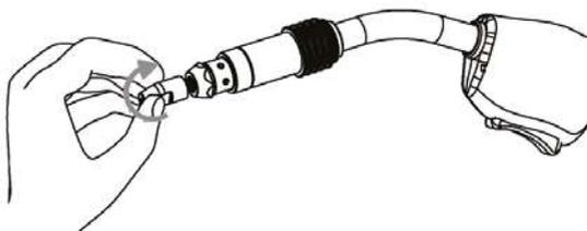
10. Закрутите прижимную гайку с помощью инструмента.
