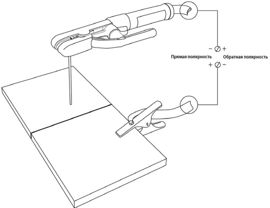
Рис. 11.7. Способы подключения.
