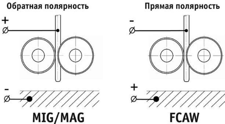
Рис. 9.1. Выбор полярности при MIG/MAG и FCAW сварке.
