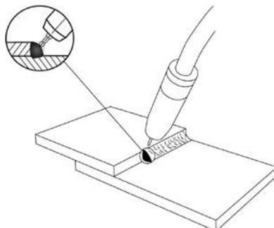
Слишком большой угол наклона горелки.
