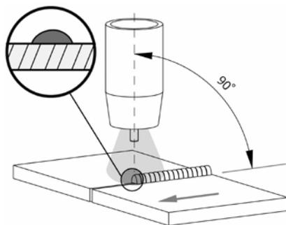
Сварка «от себя», широкий шов, небольшая глубина проплавления.
