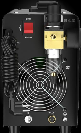
На задней панели источника установлен фильтр-регулятор, который входит в комплект поставки. Фильтр предназначен для подготовки сжатого воздуха, обеспечивая его очистку и осушение. Это важный элемент, который способствует увеличению срока службы плазменного резака и повышению качества резки
