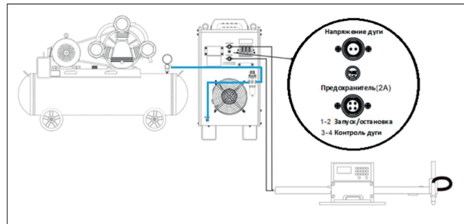
На задней панели аппарата имеются следующие разъемы подключения:
