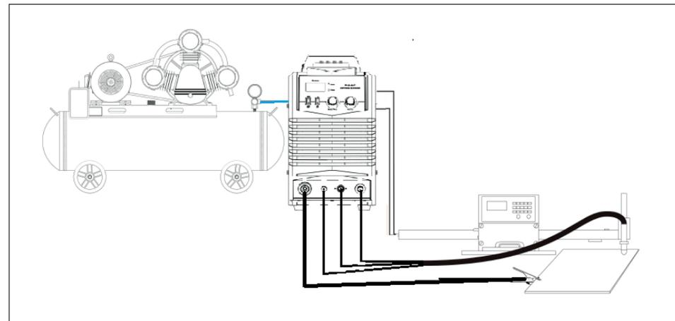
Подключение плазматрона и зажима обратного кабеля к передней панели аппарата осуществляется в той же последовательности, как и при ручном режиме плазменной резки.
