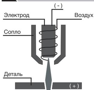
Плазма представляет собой газ, нагретый до сверхвысокой температуры, ионизированный настолько, что он становится электропроводящим. В качестве плазмообразующего газа используется воздух, поступающий от компрессора или пневмо-сети.
