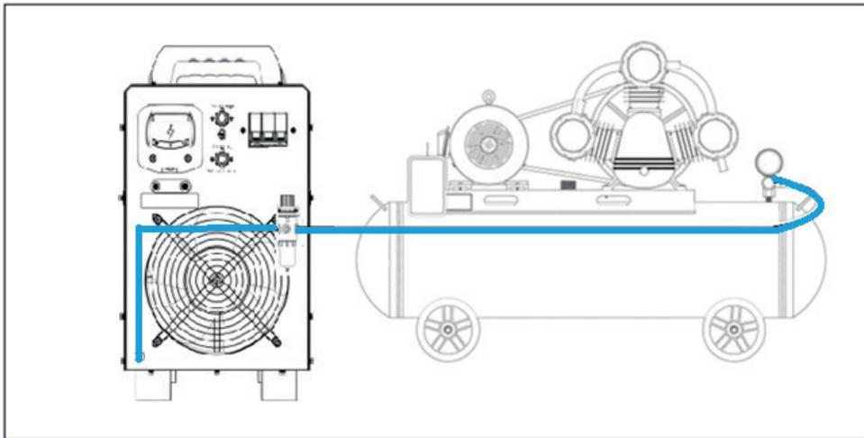
1. Подсоедините шланг от компрессора /пневмосети к впускному патрубку узла подготовки воздуха на задней панели аппарата и зафиксируйте его. Шланг, подключенный к выпускному патрубку подсоедините к штуцеру, расположенного в нижней части задней панели аппарата.
