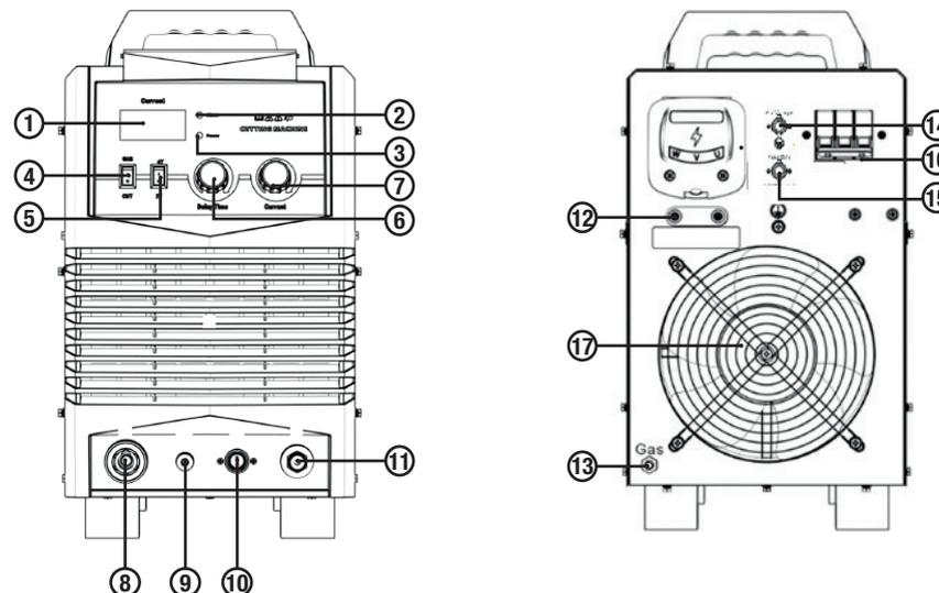
1. **Цифровой дисплей:** отображает значения тока резки.
