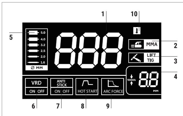
1. Экран отображения параметров сварки.
