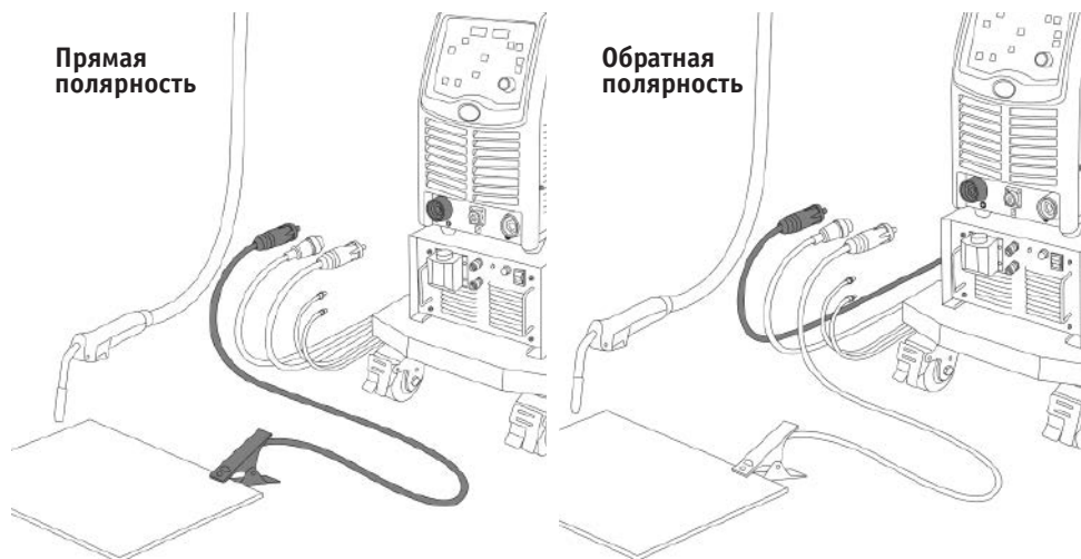
Рис. 9.1.1. Выбор полярности при MIG/MAG и FCAW сварке.
